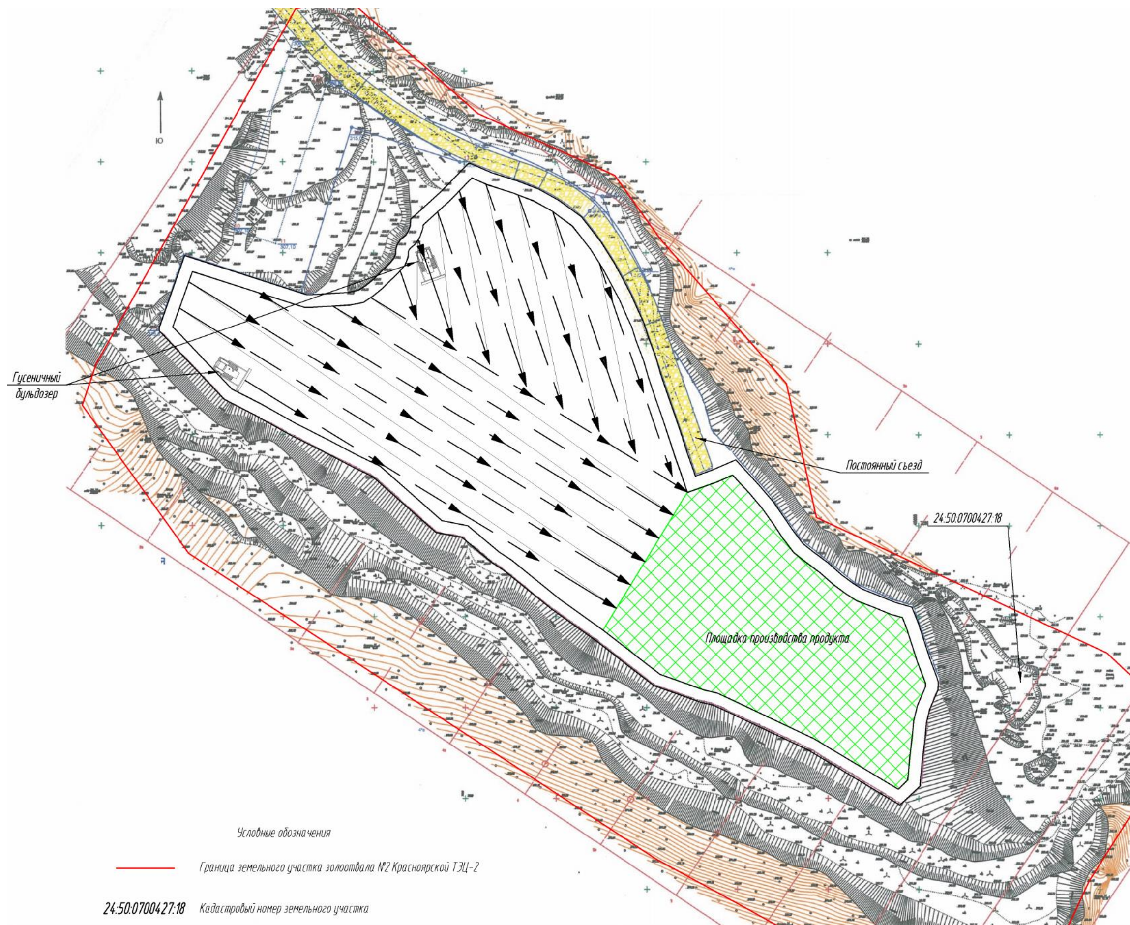
Рис. 2 – Технологическая схема перемещения ВМР на площадку производства продукта
